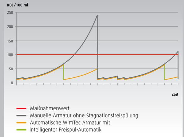
Während bei manuellen Armaturen die Bakterienzahl bei Nichtbenutzung gefährlich über den Maßnahmenwert ansteigen kann, reduziert die intelligente Freispül-Automatik der WimTec-Armaturen bedarfsgerecht das mikrobiologische Wachstum. Spülintervall und Spüldauer sind je nach Anforderung einstellbar.
