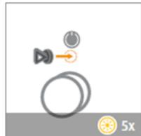
1. Heranführen des Magnetstiftes unterhalb des Infrarot-Sensors.
